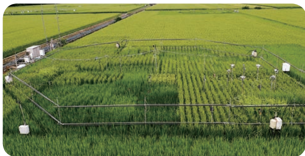
図1 FACE実験区内に設置されたT-FACE装置の様子。水田内に7角形に配置されたパイプから純CO 2 ガスを放出し、内部のCO 2 濃度を200ppm増加させることができるFACE実験装置。赤外線ヒーターを六角形に配置してイネ群落の温度を上昇させるT-FACE装置（写真右）をFACE実験区内に設置した。同じ水田内に対照区を設置（写真奥）し、3枚の水田で実験した。
