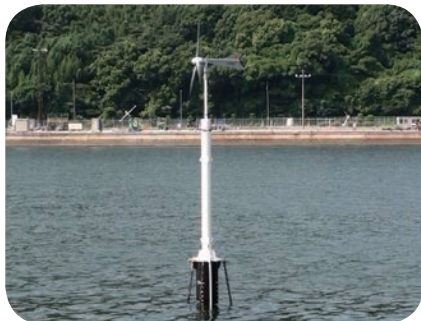
図1 ハイブリッドスパー型実証機(2MW)の1/10スケールモデルによる実海域実験(2009.8実施)
