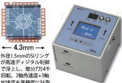
図1 静電浮上回転ジャイロとそれを用いた列車動揺計測装置(東京計器株)
