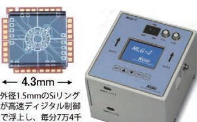
図1 静電浮上回転ジャイロとそれを用いた列車動搖計測装置(東京計器株)
