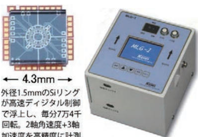
図1 静電浮上回転ジャイロとそれを用いた列車動揺計測装置(東京計器株)
