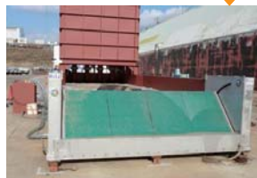
図2 段波状津波によるフラップゲート扉体の起立の様子
