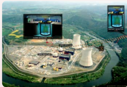
図1 ダブルショー実験場。原子炉から1kmの場所にニュートリノ検出器(右)を設置し、原子炉から飛来するニュートリノを検出しました。もう一台のニュートリノ検出器(左)は現在建設中です。2台の検出器を使用するため「ダブルショー実験」と呼ばれています。
