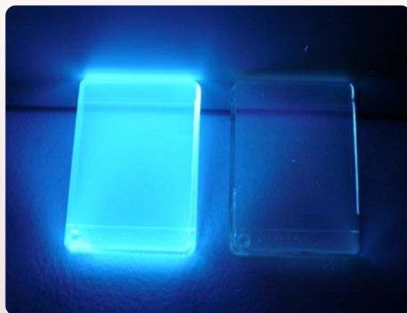
図2: 放射線蛍光プラスチック 蛍光試験の様子。放射線蛍光プラスチック(左)と単なるプラスチック(右)
