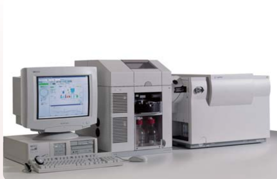
図1 メタボローム測定を可能にしたCE-MS装置
