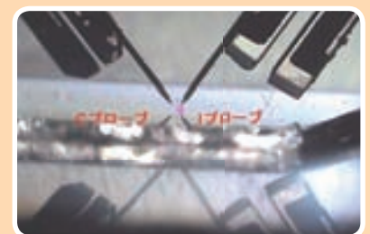
▲図2 試作された近接場2プローブ分光装置
