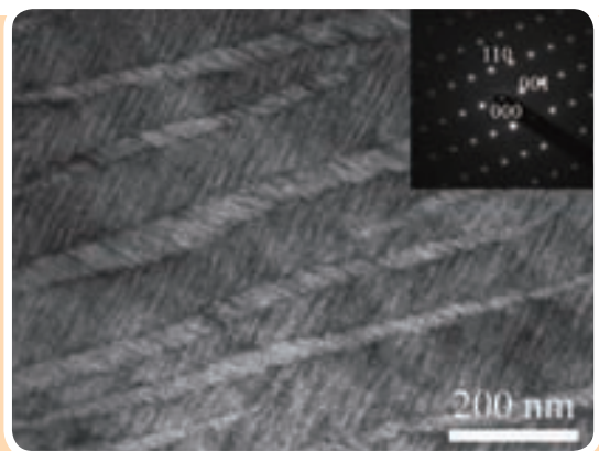
▲図2 PMN-32%PTにおける単斜晶相での階層的なドメイン構造
