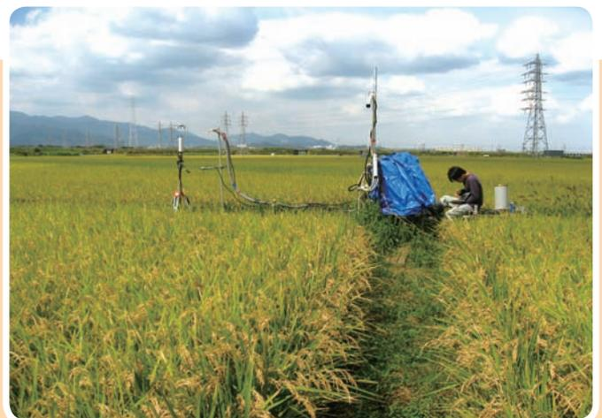
▲写真1 神奈川県平塚市の営農水田に設置した温室効果ガス発生量測定装置
