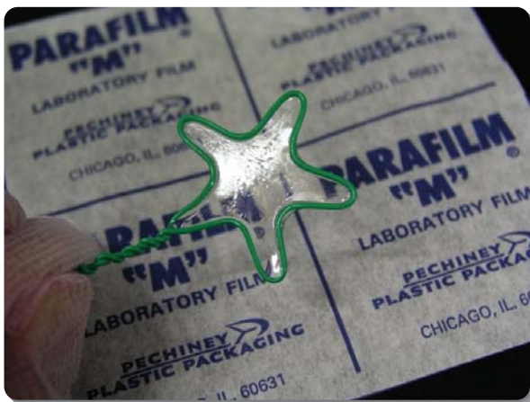
図1 星型ループにすくい取ったナノシート。空気中に放置しても破けない。
