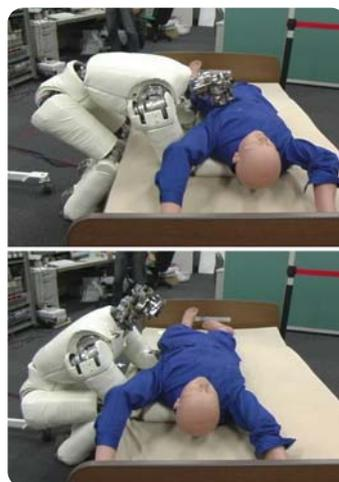
図2 66kgの人体模型の引き寄せ動作
