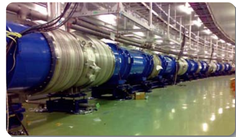
図2 J-PARCのニュートリノ生成施設で陽子ビームを転送するための超伝導ビームライン。偏向磁場と収束磁場を同時に発生させる複合機能磁石28台からなる。加速器実験で超伝導複合機能磁石が本格的に利用されるのは世界初。
