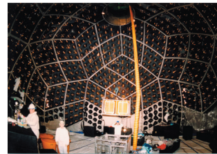
図1 カムランド内部の建設時の写真 研究者が壁一面に光センサーを取り付けました。
