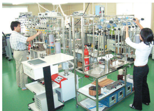
写真1 歴博で使用中の炭素精製装置で、不純物を除いた試料をさらに精製して測定用試料を作成
