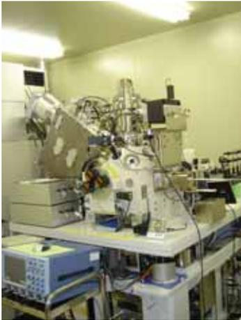
( 3 ) 1 次イオン照射系については Ga 液体金属イオン銃を用いた収束イオンビーム装置を採用し、質量分析計とレーザーを組み合わせることにより全く新しい分析システムとしてまとめた。
