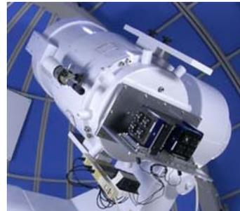
図1. GRB専用50cm『三つ目』望遠鏡(岡山)。新規開発3色同時撮像カメラが装着されている。
