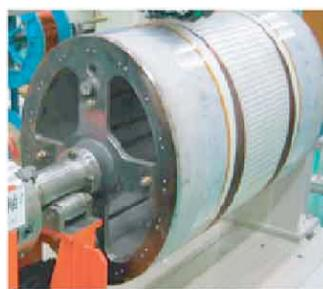
図7 楕円形超伝導電磁石コイル試作品
