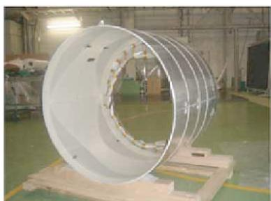
図6 超伝導 FFAG 電磁石プロトタイプ
