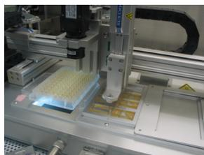
図6. コロニーをカメラで自動的に認識してピックアップし、NMR測定用デバイス上に整列させるロボット。この機器を開発したことにより、極めて高密度に酵母を植菌することができるようになった。
