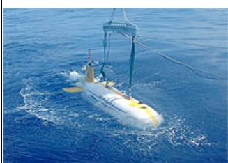
本プロジェクト最終年度となる2005年度8月、「r2D4」は、热水鉱床発見のために伊豆小笠原海域の明神礁カルデラに潜航。「r2D4」はカルデラ底の水深1,100mからカルデラ縁水深500mの間を測線に沿って往復し、搭載するマンガンイオン濃度計の計測データによりカルデラ内に热水活動がある確証を得、中央火口丘の北西斜面の形をインターフェロメトリーソナーにより詳細に観測し、取得したデータの解析により極めて精度の高いカルデラ内傾斜面の画像を取得した。明神礁周辺は海況が悪いことが多く、海底火山爆発の危険もあるため、ROVの展開もおこなわれた事はない。「r2D4」の明神礁潜航成功が示唆することは、「r2D4」のような無人機が多様で複雑な海域の観測に有効なことを証明しており、今後の海洋観測における無人機の活躍の可能性の拡大を意味する。
