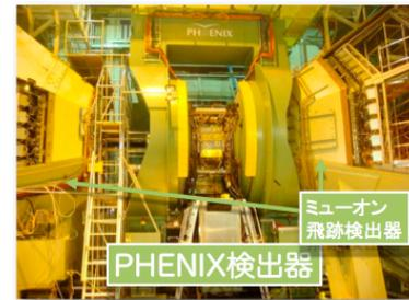
同定されるが、我々の検出器PHENIXには10 MHzで起こる雑多な事象の中からそのような事象を選び出してデータ収集する機能がなかった。そこで本研究では、ミュオン飛跡検出器の情報をオンラインで取り出し、高運動量ミュオン、つまり磁場中で殆ど曲がらない飛跡を探し出す機能を導入してWの検出を可能にするものである。
