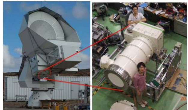
図1 現在POLARBEARプロジェクトで使用中の電波望遠鏡(左)および、開発中のPOLARBEAR-2検出器システム(右)。
