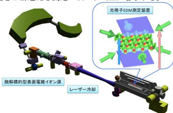
図1 レーザー冷却光格子EDM測定装置
