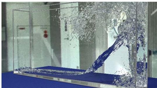
弱圧縮性流体計算による完全陽解法の気液二相流計算
