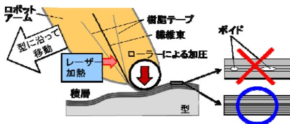
図1 直接その場成形法概念図
