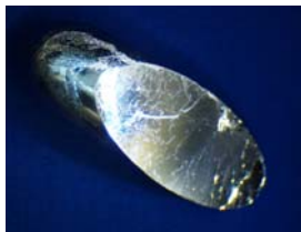
図1 トポロジカル絶縁体のバルク単結晶試料（左）とMBE法薄膜試料（右）
