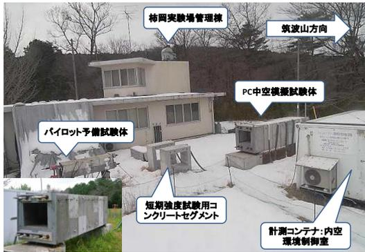
図1 柿岡教育研究施設での暴露試験
