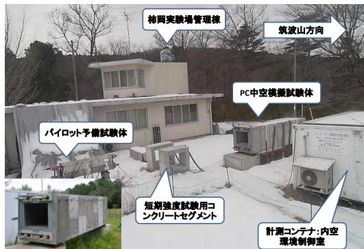
図1 柿岡教育研究施設での暴露試験
