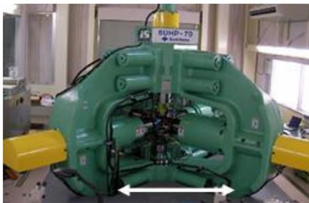
新型 6 軸プレス全景：各軸の推力は 600 トンである。各軸独立に精密制御できることが特徴である。図中に示したスケールは約 2m である。
