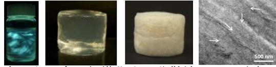
左から、自己組織化ナノ分散液、99.6%水の高剛性ヒドロゲル、超高比表面積低密度エアロゲル、ガスバリア性の多層状フィルム断面
