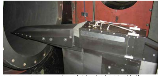
図1 インレットの極超音速風洞試験
