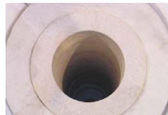
図3 高温ガス加熱器内のセラミックス
