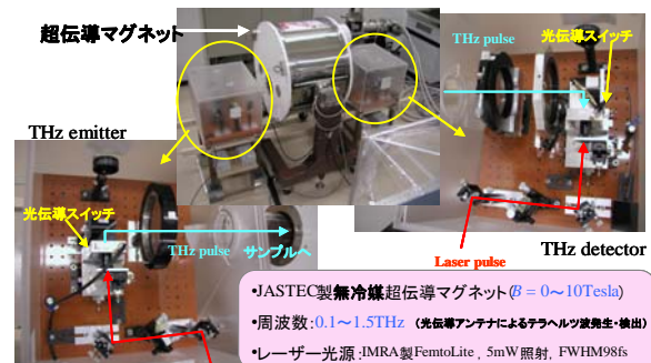
図 1 ヘリウムレス超伝導マグネットを用いたテラヘルツ磁気光学効果測定システム
