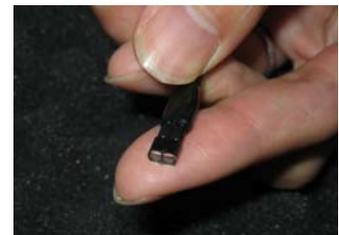
図2 開発した小型ステレオ CCD カメラモジュール
