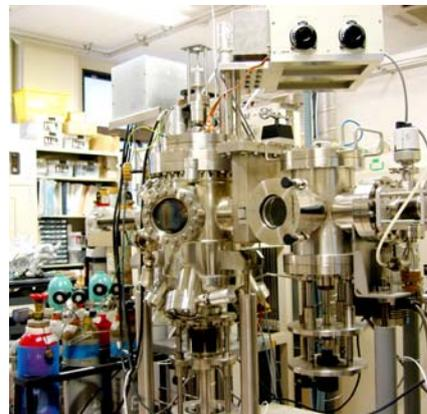
図 1: 超高真空スパッタ装置
