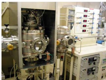
図 2: ICP-CVD 装置
