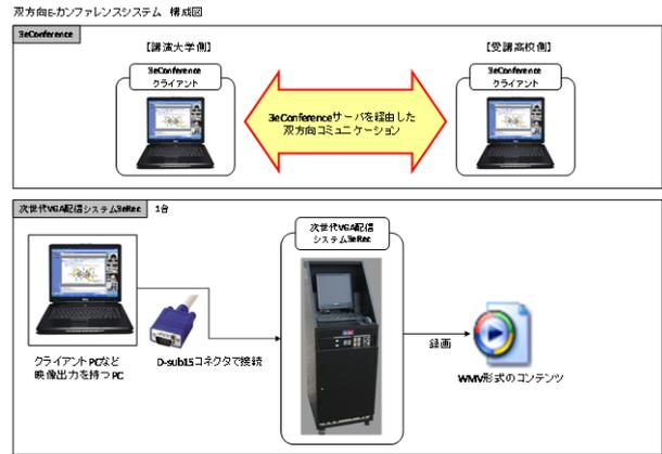
図2 本学が導入した双方向E-カンファレンスシステムの概念図(木村情報技術株式会社開発)。本システムは3eカンファレンスとよばれる一般的なLAN環境に接続されたパソコンならばほとんどの機種でも利用できる汎用性の高いソフト型テレビ会議システムと、録音に収録し、収録形式で配信するe-Learningシステムである次世代VGA配信システム3eConを融合したシステムであり、北海道の遠隔地にある学校や医療機関などとの遠隔に最適な装置である。
