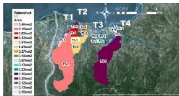
図-11 スペースシャトルのデータを用いた流域界と流域面積の決定
