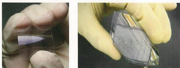
図4. 曲がる高性能透明トランジスタとそれを使った電子ペーパー
