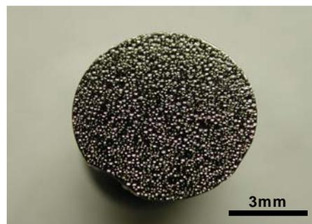
図7 多孔質バルク金属ガラスの断面写真
