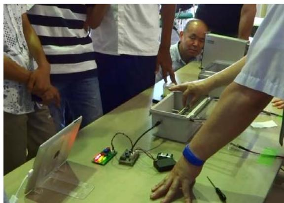
標準線源からのアルファ線を計測。パルスカウンターのLEDが点滅し、計数を示す。
