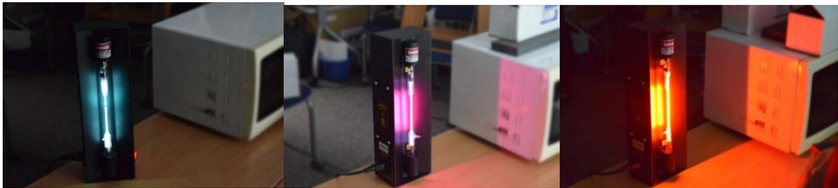
(左・中・右)それぞれ異なる気体をガラス管に封入し両端の電極に電圧をかけると特徴的な光の放電を呈する。それぞれ何の気体が封入されているかわかりますか？
