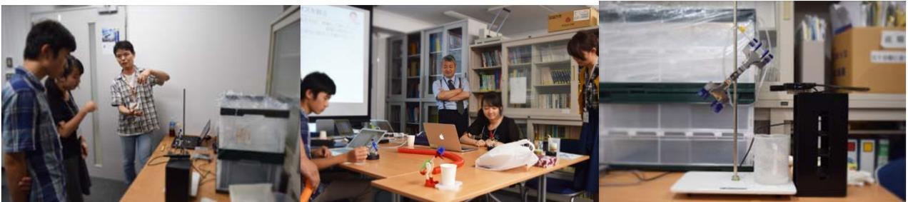
(左)水滴落下装置 右側のコンテナが水のタンク (中)水滴落下間隔のデータを表計算ソフトで解析(右)水滴落下間隔の測定部分。高い位置にある水タンクからサイフォンの原理を使って、細いチューブから水を細い管から滴下する。滴下部分に赤外線フォトゲートを置き、落下間隔を測定する。
