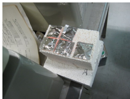
写真5 取り出した固相反応法の試料(白金容器に密封)
