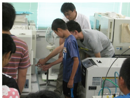
写真3 固相反応法試料を電気炉にセットしスイッチオン
