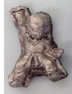
造形した物を焼いて、磨き上げて完成！ 開発技術で、機械を使わず自分の手だけで金属を造形できました
