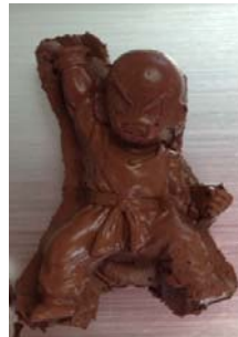
造形した物を焼いて、磨き上げて完成！ 開発技術で、機械を使わず自分の手だけで金属を造形できました
