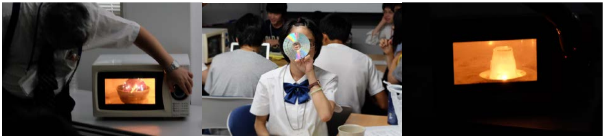
(左)CD を電子レンジに入れて作動させると記録面上で放電し... (中)その CD を電子レンジから取り出すとこうなっていた。放電が生じた道筋が記録面に残っている。(右)電子レンジで作成したプラズマ
