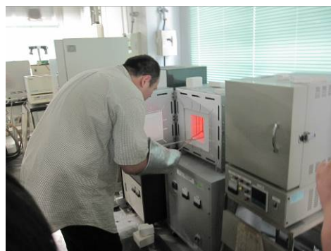
写真7 電気炉から試料を取出し
