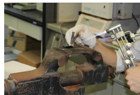
写真5 試料を白金容器中に封入
