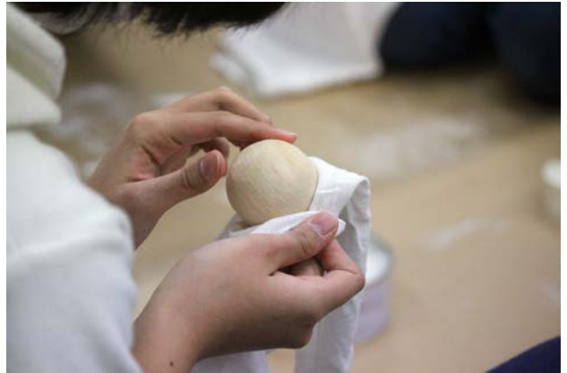
6. 実習：木の表面にシッカロールをつけてなじませた後、ワックスを塗ってツヤを出す（作業風景 2）
