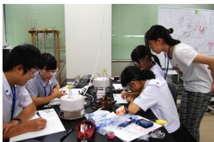
デジタル温度センサーを2本用いて示差熱分析実験。酢酸ナトリウムの分解に伴う吸熱ピークと過冷却状態を実験。午前中に受講生に配布した温度センサーを利用し、2名1組で実験を行った。
