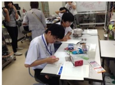
デジタル温度センサーを2本用いて示差熱分析実験。低温ハンダの溶解による吸熱ピークと凝固による発熱ピークを観測した。
