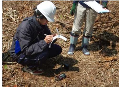
土壤水分センサーによる測定
