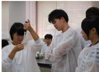
植物実験で最もよく使われるシロイヌナズナという植物の葉からDNAを抽出し、PCR法と呼ばれる判別方法で遺伝子組換え体と非組換え体を判別します。2種類のシロイヌナズナの葉をそれぞれ水と混ぜてすりつぶすことでゲノムを抽出した後、酵素液と抽出液を混ぜ合わせ、できあがったサンプルをPCRの機械にセットします。
