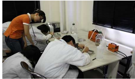
実験③ 沈底法を用いた試料の粒径篩別
